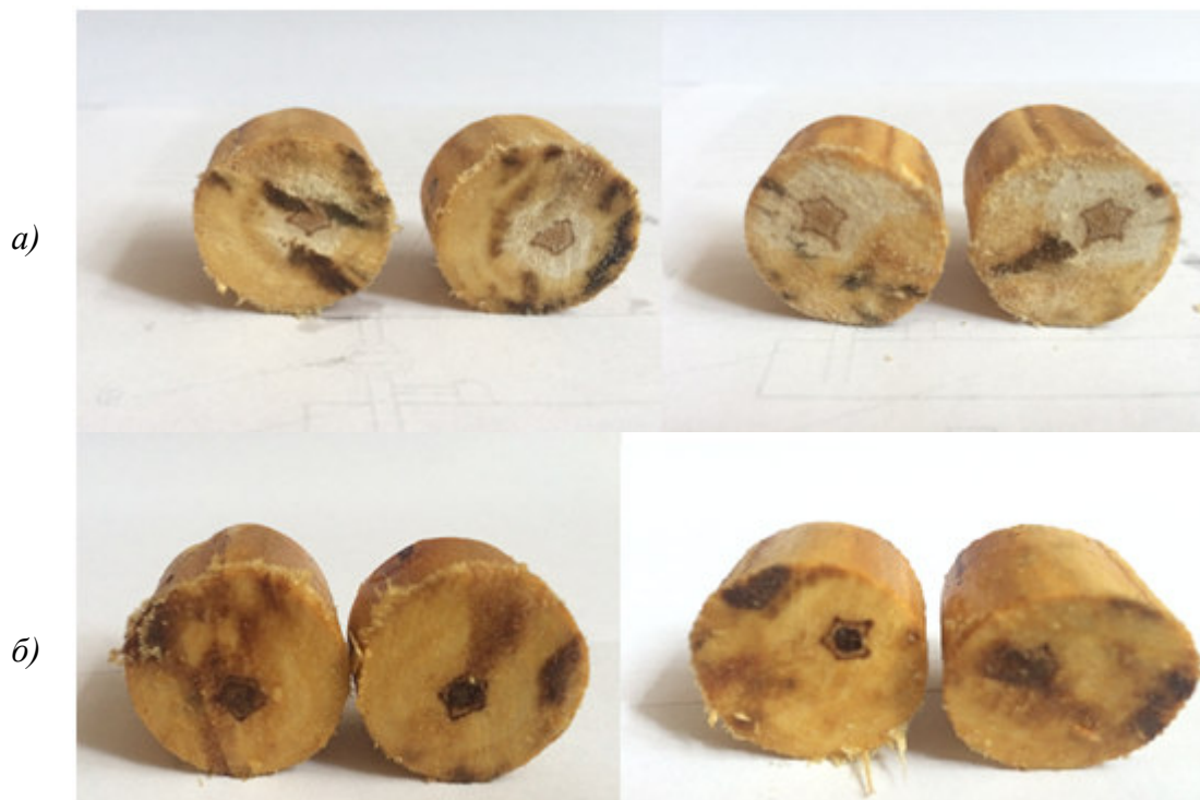
Рис. 2. Розрізані дослідні зразки після імпрегнування з використанням: а) статичного тиску; б) циклічних імпульсів тиску
