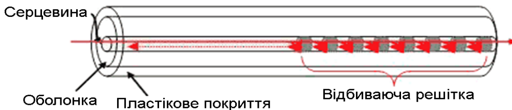
Рисунок 1 – Схематичне зображення волоконної бреггівської решітки
