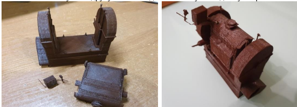
Рис. 10 – Надруковані частини моделі та модель тістоміси в зборі Fig. 10 – Printed model parts and dough bowl model assembly
