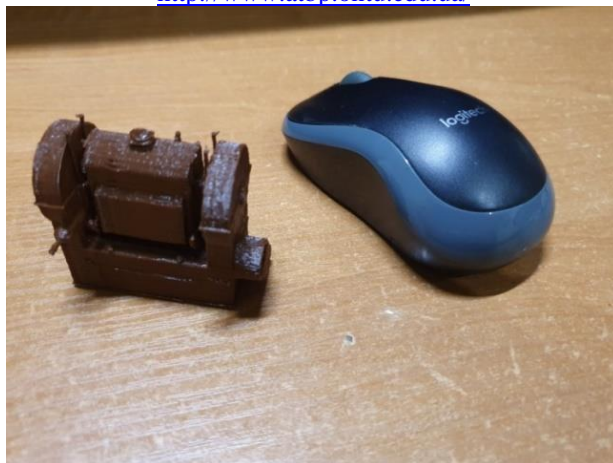
Рис. 9 – Надрукована зменшена модель тістоміси Fig. 9 – Printed reduced model of the dough bowl
