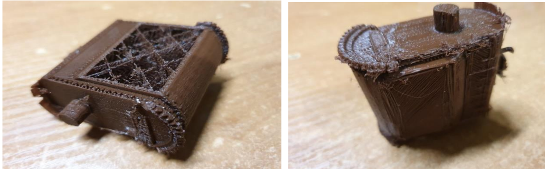
Рис. 7 – Невдалі спроби друку частин тістомісу по створеній 3D-моделі
