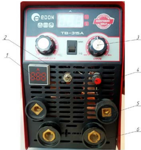
Рис. 5. Передня панель інверторного джерела живлення після переробки: 1 — амперметр мережі живлення; 2 — перемикач режиму роботи індукційний підігрів-зварювання; 3 — регулятор сили струму; 4 — регулятор частоти при індукційному нагріві; 5 — виводи на індукційний нагрів; 6 — виводи на зварювання
