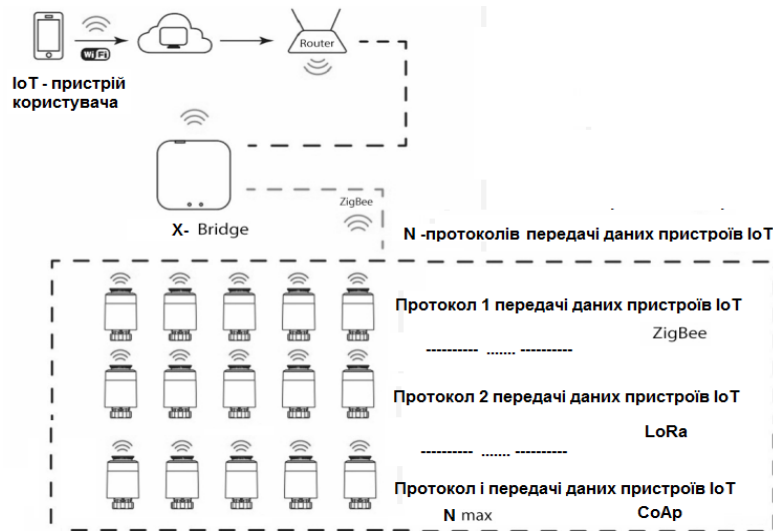
Рис. 5. Принцип підвищення безпеки на базі схеми розділених комунікацій пристроїв IoT на основі підходу використання комутації різних протоколів IoT у поєднанні з ZTA-підходом в архітектурі IoT
