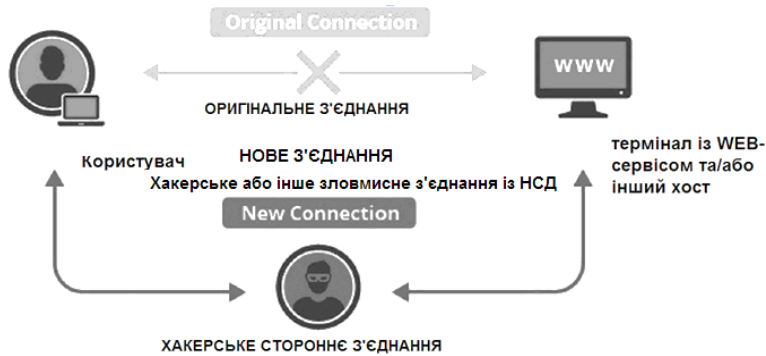
Рис. 1. Основна схема реалізації атак в каналах і комунікаціях IoT типу MITM («Людина посередині»)
