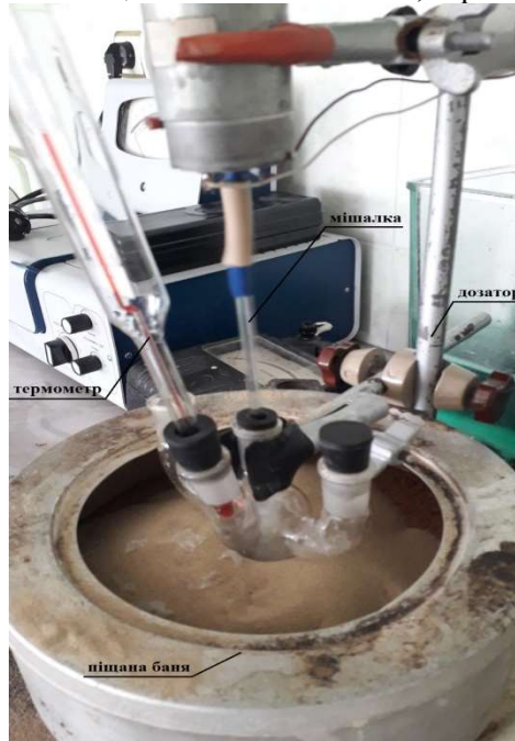
Рисунок 1 – Лабораторна реалізація деревоощадливої технології отримання синтетичного паперу
