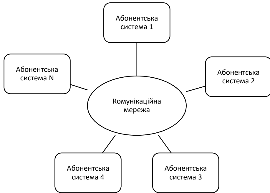
Рисунок 5.1 – Узагальнена структура комп’ютерної мережі
