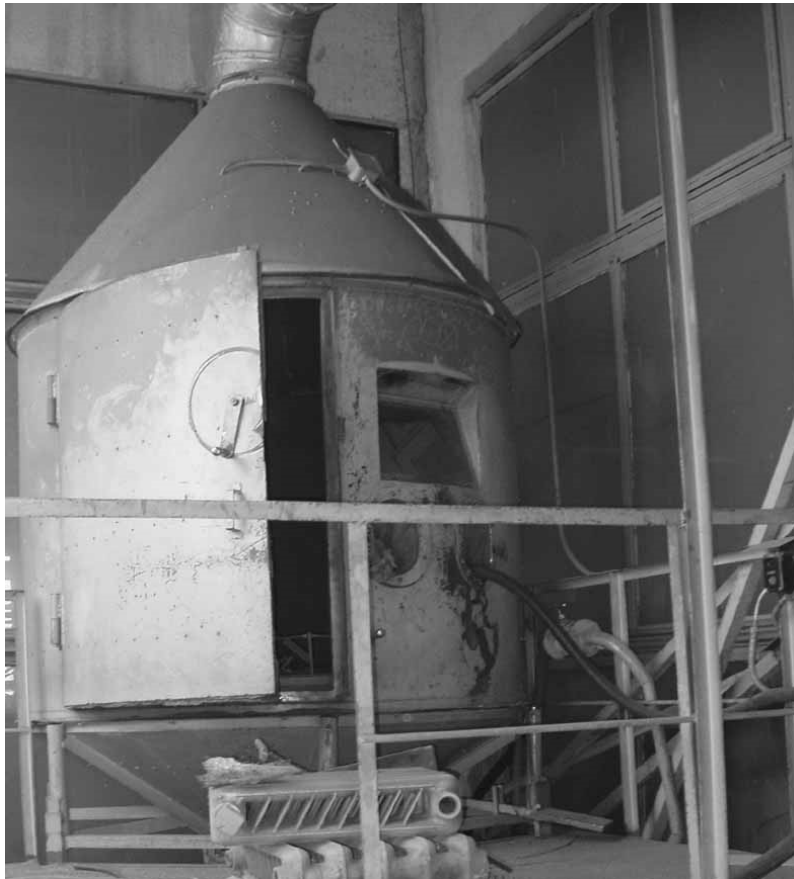
Рис. 4.4. Дробеструминна установка для обробки деталей веж розміром до 1000x1000x500 мм
