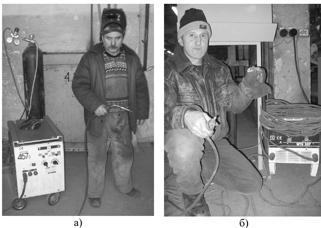
Рис. 4.15. Зварювальне обладнання: а – напівавтомат Vario Star 457-2 для зварюванні у середовищі вуглекислого газу, б – апарат для ручного електродугового зварювання Fronius VTU307
