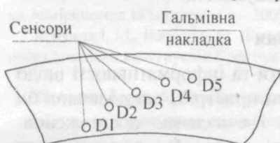
Рис. 4. Розміщення сенсорів по товщині гальмівної накладки
