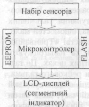
Рис. 3. Структура пристрою для діагностування барабанно-колодкового гальма
