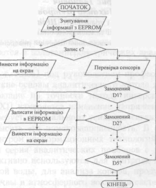
Рис. 6. Алгоритм роботи арифметико-логічного пристрою
