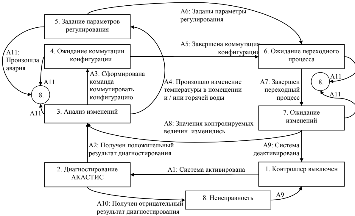
Рис. 5. Диаграмма переходов в состоянии «главного контроллера» системы управления
