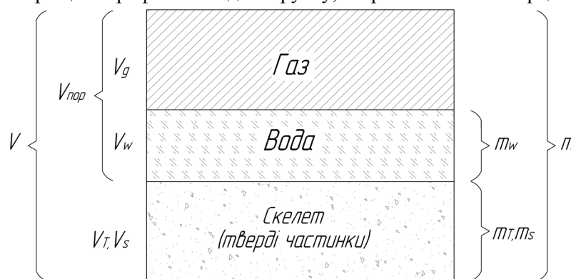
Рис. 1. Графічна схема ґрунту як трифазової системи (спрощена ідеалізована модель К. Терцагі)
