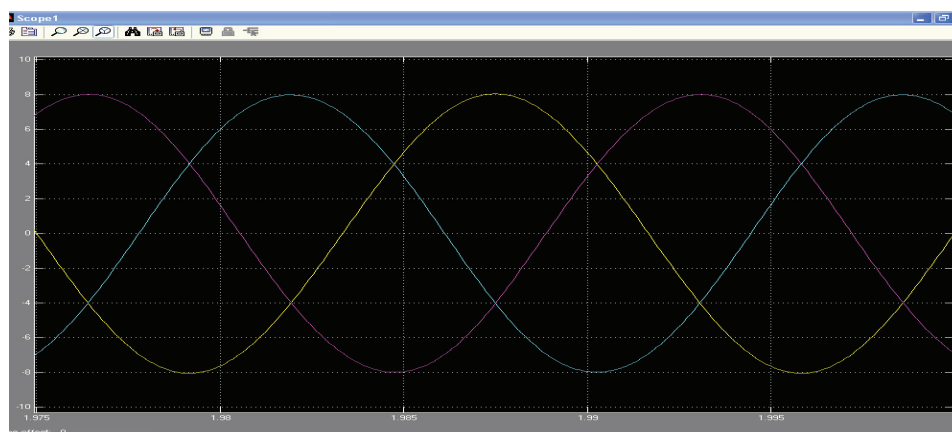
Рис. 2. Лінійні струми у разі компенсації реактивної потужності
