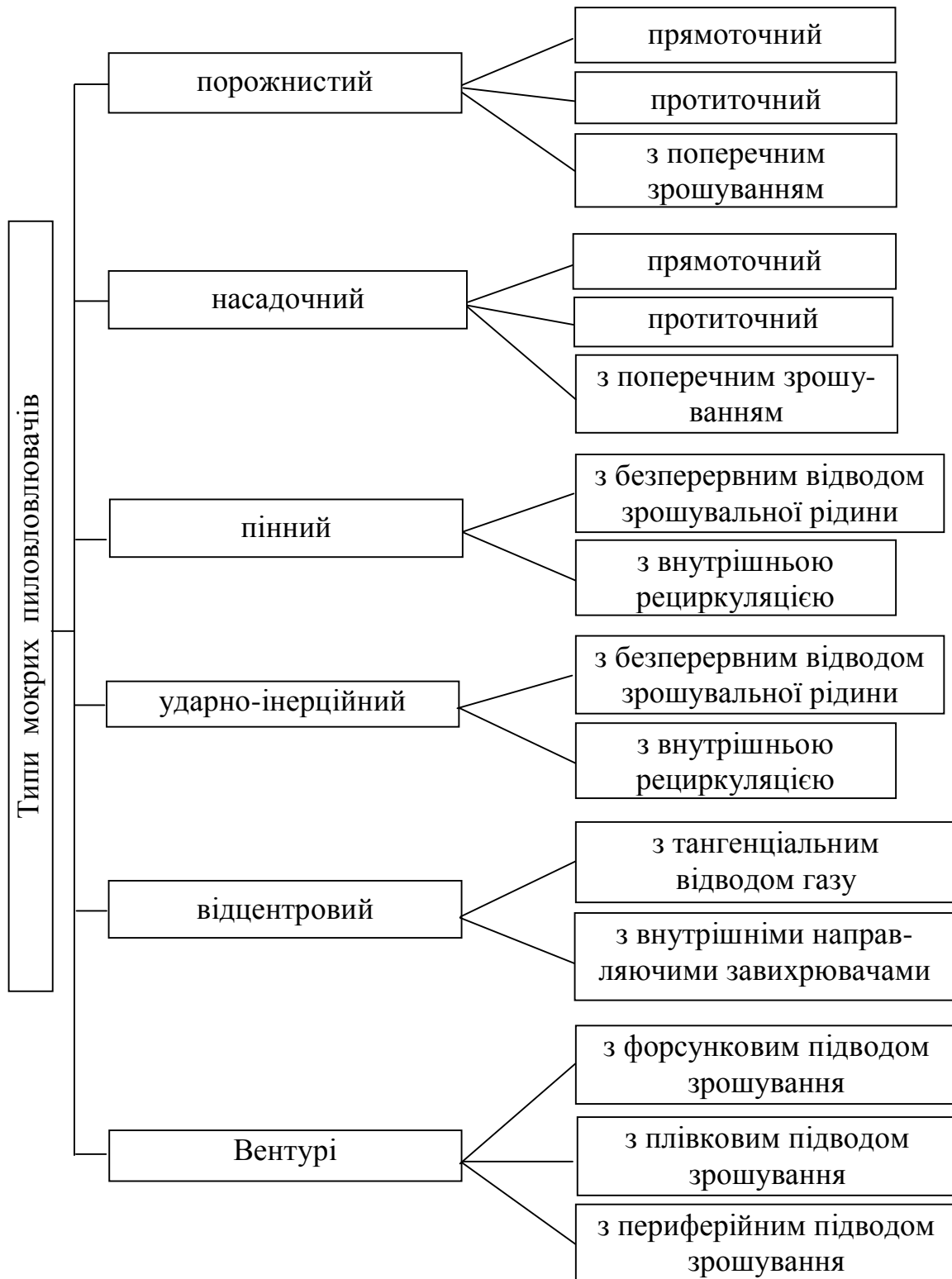
Рисунок 3.1 – Класифікація мокрих пиловловлювачів
