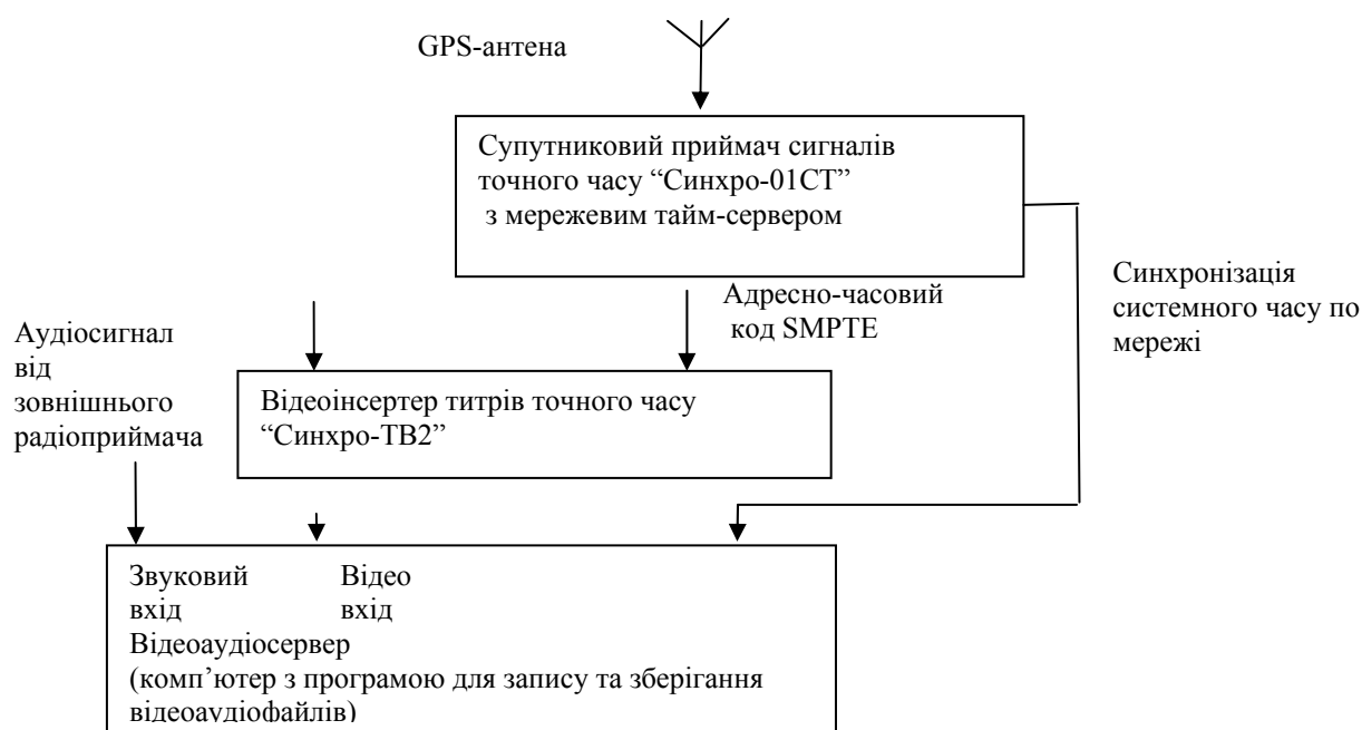
Рисунок 1 Структурна схема вимірювального каналу „Синхро” в режимі запису
