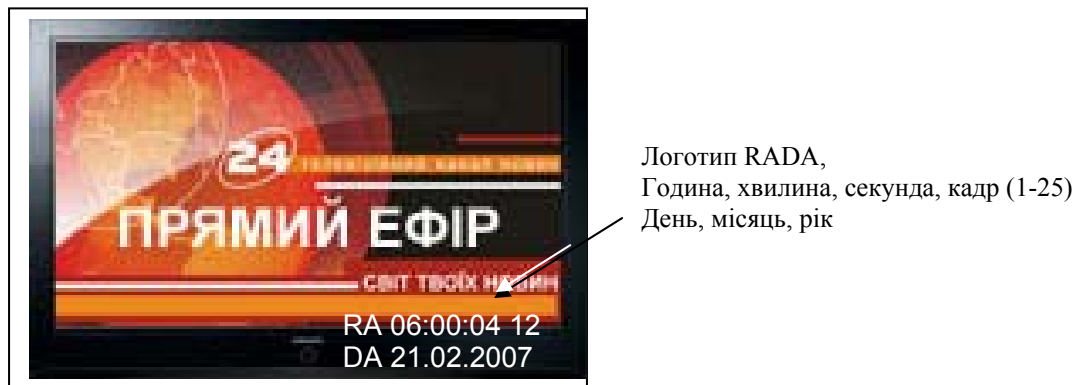
Рисунок 2 Формат титрів точного часу на кожному кадрі відеофайлів
