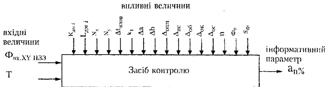
Рис. 4. Узагальнена схема перетворення інформативного сигналу на засіб контролю
