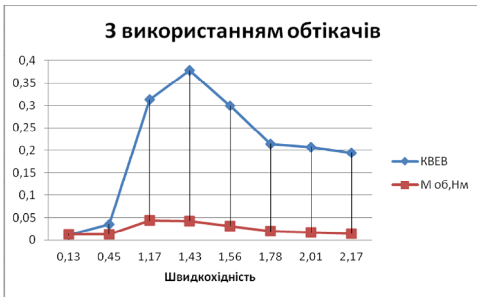
Рисунок 3 — Залежності обертового моменту M_{об} та КВЕВ від швидкохідності з використанням обтікачів
