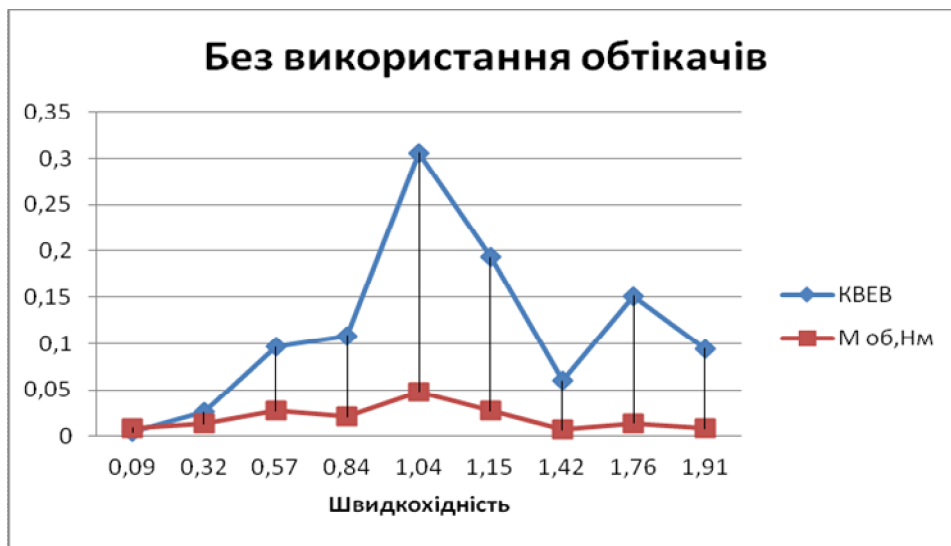
Рисунок 2 — Залежності обертового моменту M_{об} та КВЕВ від швидкохідності без використання обтікачів
