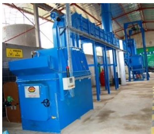
а) б) Рис. 1. Піролізна установка для утилізації відходів Ati-Incinerateurs Muller: а – загальний вигляд; б – конструктивна схема
