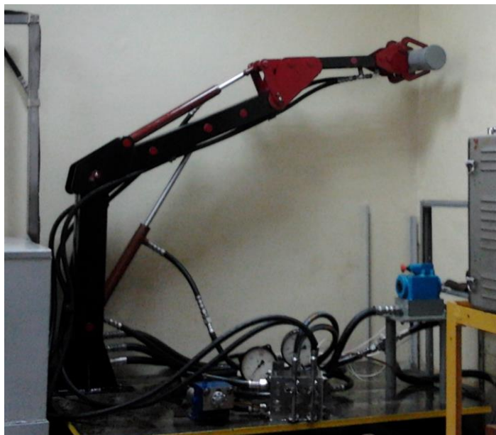
Рис. 1 – Фото виготовленого дослідного зразка гідроманіпулятора
