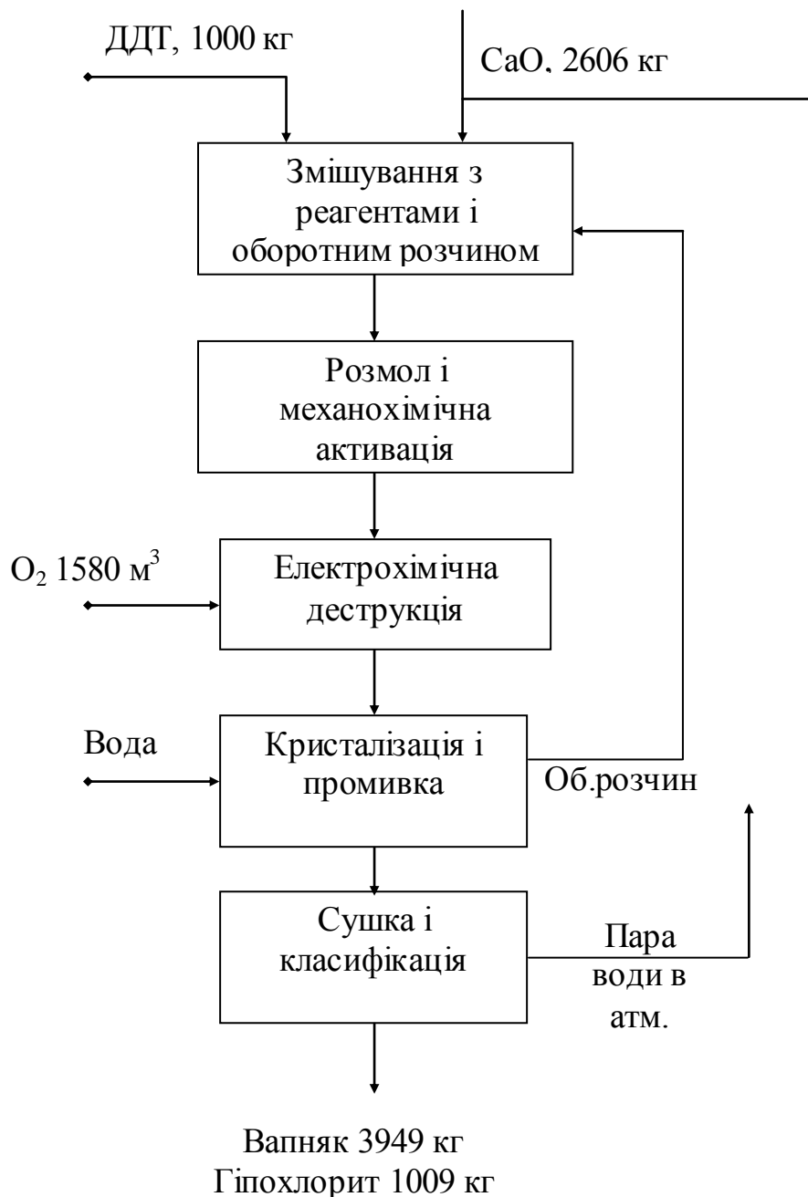
Рисунок 2.25 – Технологічна балансова схема утилізації ДДТ
