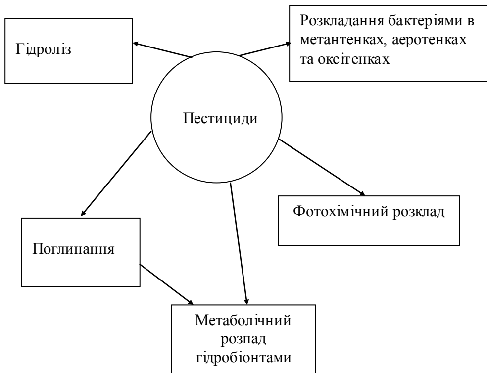
Рисунок 2.33 – Загальна схема утилізації пестицидів в системах біологічного очищення
