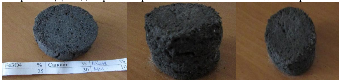
Рис.1. Пористий проникливий матеріал отриманий методом СВС
