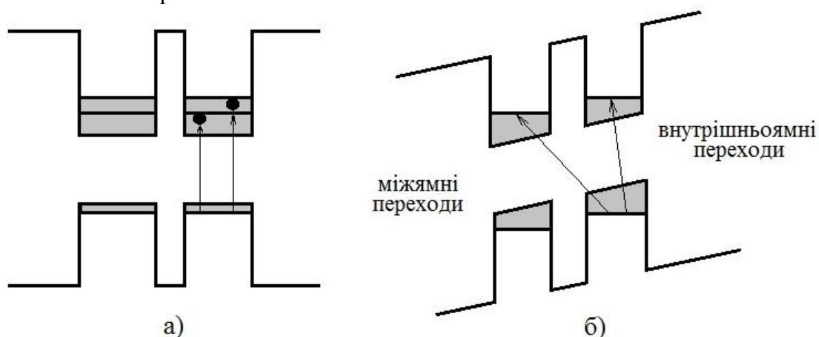
Рисунок 5.7 – Схематичне зображення симетричної подвійної зв'язаної ями, що демонструє механізм оптичних переходів з діркового стану у правій квантовій ямі при відсутності електричного поля (а); при прикладенні зовнішнього електричного поля стани локалізуються в одній з ям (б)
