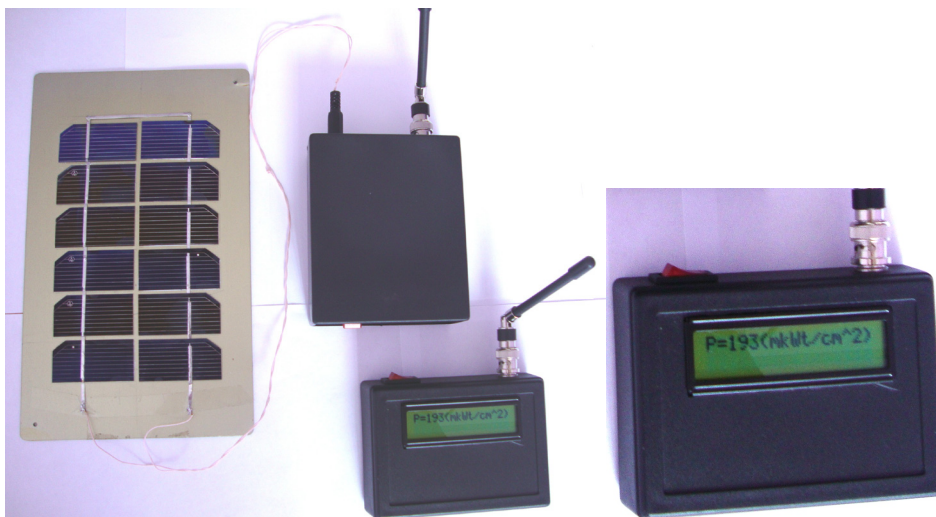
Рисунок 5.8 – Зовнішній вигляд передавального та приймального блоків для вимірювання оптичної потужності з дистанційною безпроводною передачею результатів
