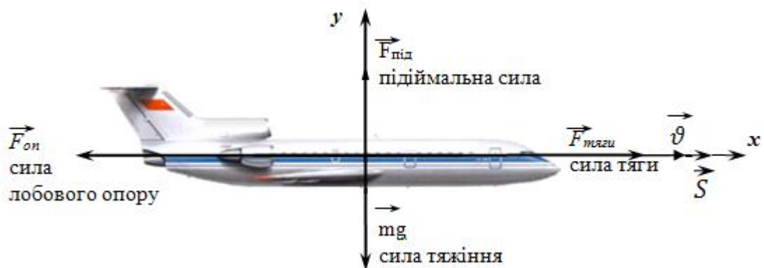
Рисунок 1 Сили, що діють на літак у горизонтальному польоті
