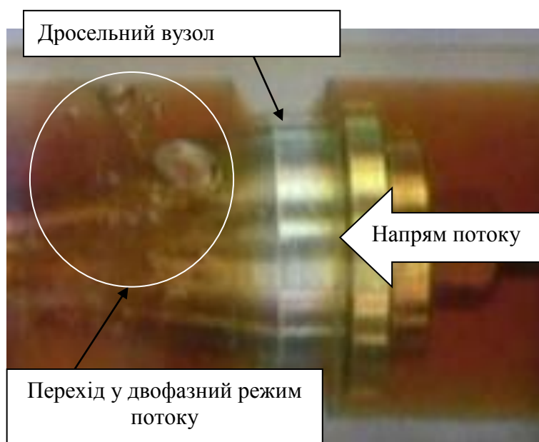
Рисунок 2 – Візуальна картина течії потоку через дросельний отвір та за ним (рух рідини з права на ліво, \Delta p=10 бар, t=30 °С, Q=5 \cdot 10^{-5} м 3 /с, швидкість фотозйомки 200 кадрів в секунду, площа дроселя 0,00023 м 2 )
