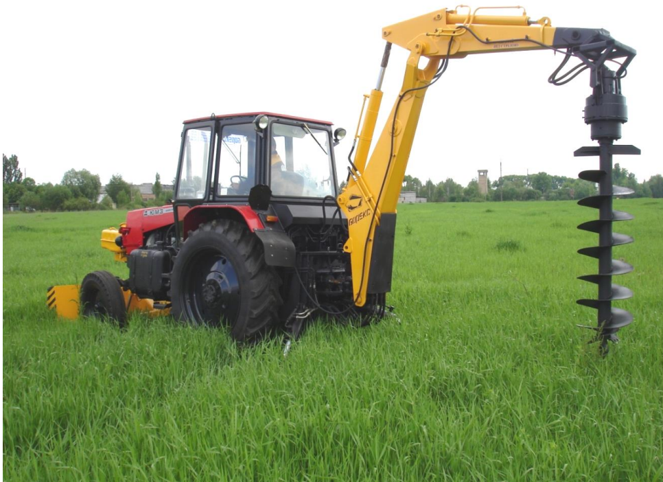
Рисунок 1 – Бурильне обладнання на базі трактора
