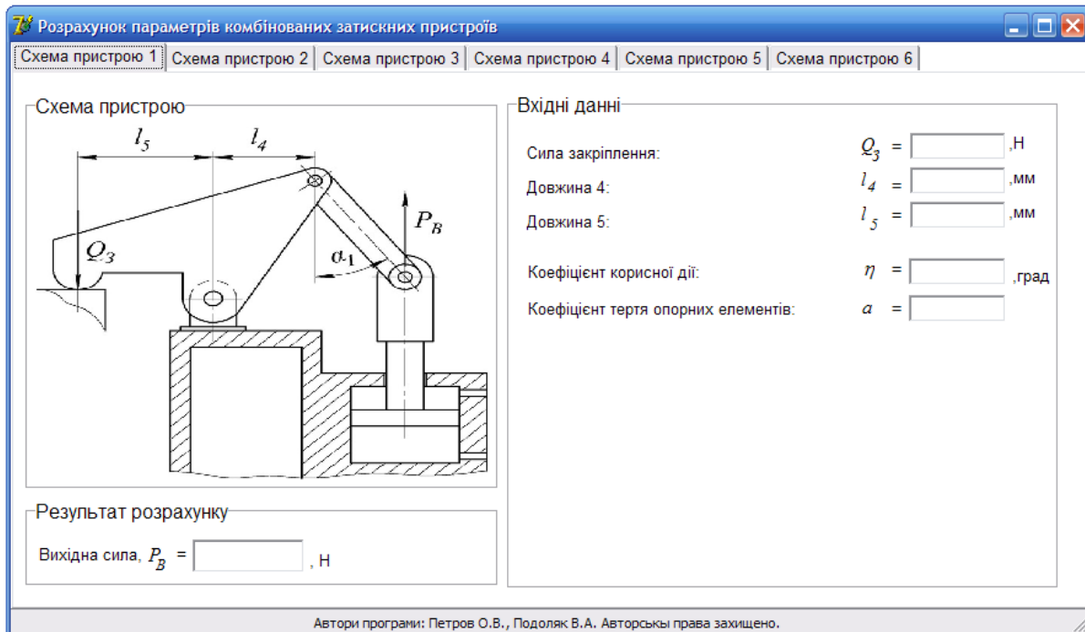
Рисунок 1 – Інтерфейс програми розрахунку параметрів затискного пристрою з пневматичним циліндром
