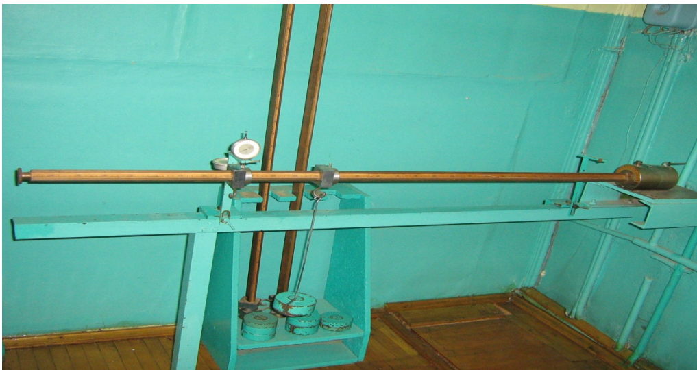
Рисунок 1.2 – Установка для визначення повних прогинів балки
