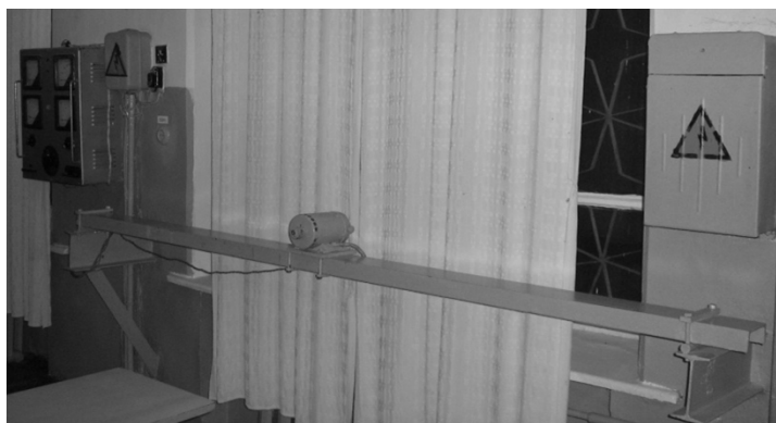
Рисунок 11.3 – Установка для дослідження коливання пружної системи з одним ступенем вільності
