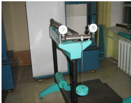
Рисунок 2.5 – Установка для визначення положення центра згину швелера
