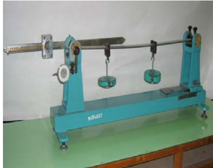
Рисунок 6.7 – Установка для визначення опорного моменту один раз статично невизначуваної балки
