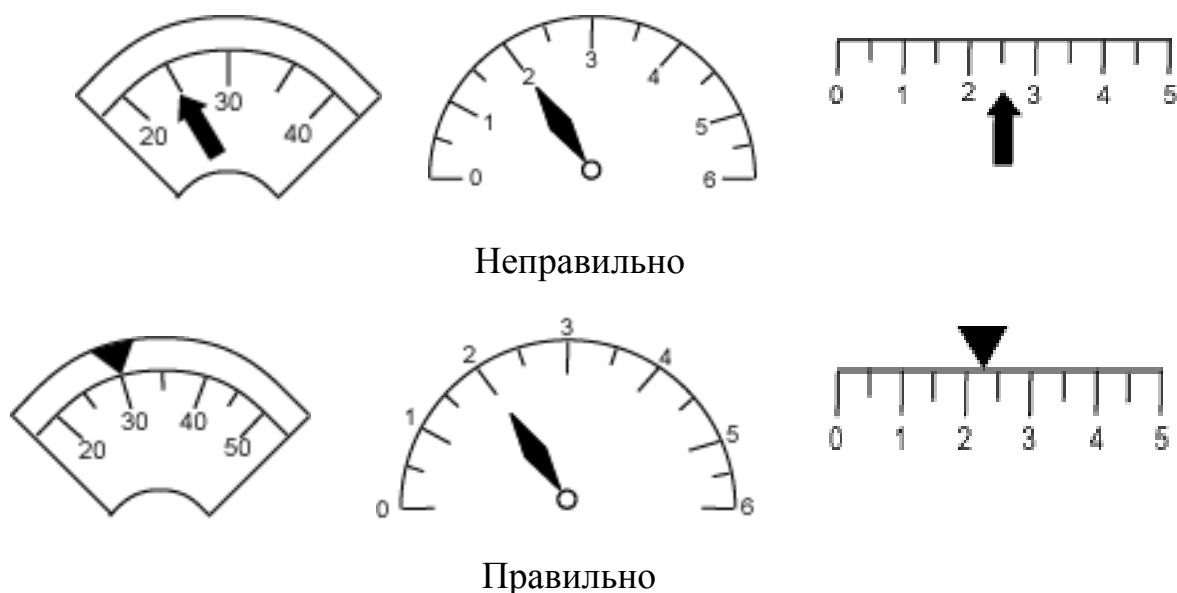
Рис. 8. Приклади правильного і неправильного оформлення шкал вимірювальних приладів
