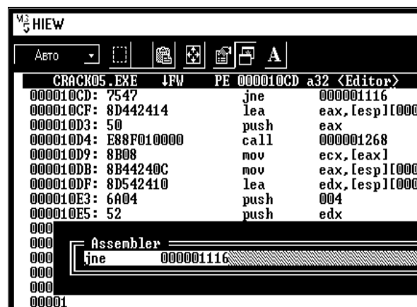
Рисунок 7.17 – Вікно редагування коду програми: а – режим зміни 16-кового коду команди; б – режим зміни команди асемблера
