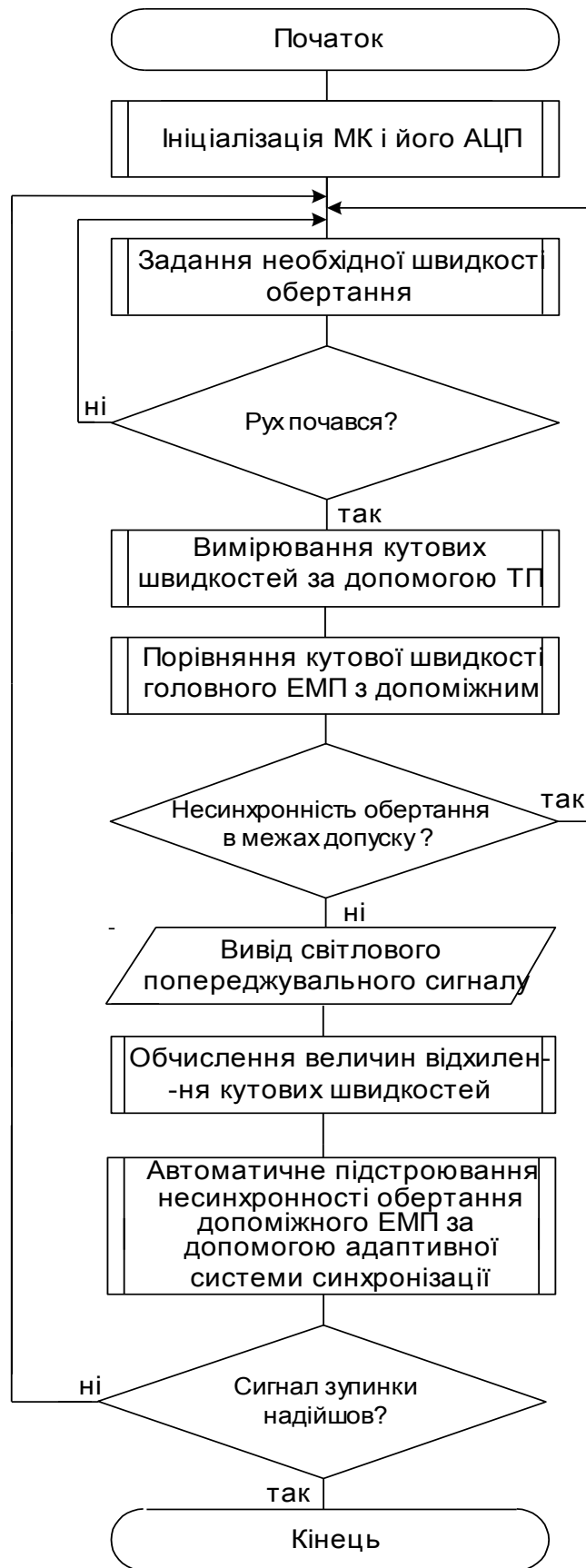
Рис. 4.1. Алгоритм роботи процесу вимірювання та синхронізації кутових швидкостей роторів декількох ЕМ
