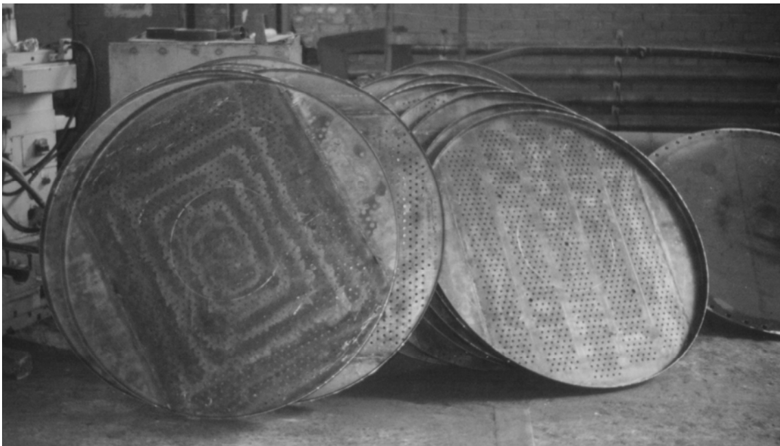
Рис. 4.10. Вироби, отримані ротаційною витяжкою конічним валком
