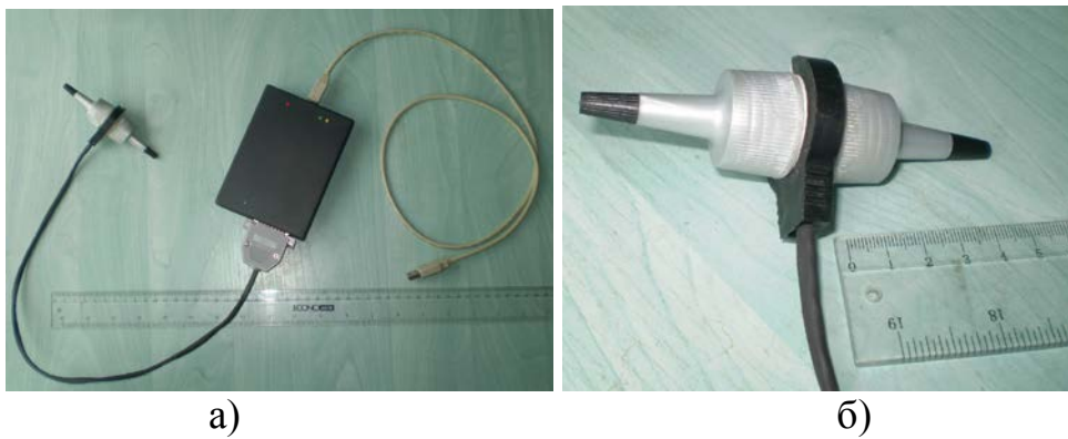
Рисунок Б.2. – Фотографія сенсорного пристрою вимірювання потоку (а) та його вузол первинного перетворювача (б)
