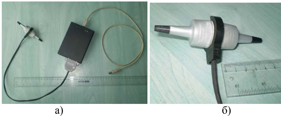
Рисунок 4.37 – Фотографія сенсорного пристрою вимірювання потоку (а) та його вузол первинного перетворювача (б)
