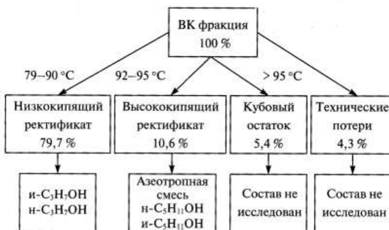
Рис. 4. Результаты ректификационной перегонки ВК фракции
