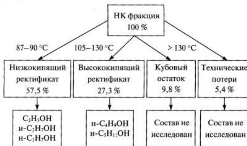
Рис. 3. Результаты ректификационной перегонки НК фракции
