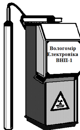
Рисунок 1.2 – Нейтронний вологомір ВНП-1
