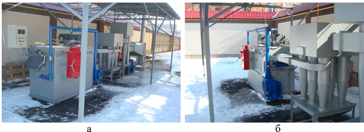
Рис. 1. Общий вид пиролизной установки для утилизации медицинских отходов: а - вид спереди; б - вид сзади
