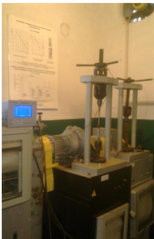
Рисунок 6 - Загальний вигляд (а) та кінематична схема (б) установки УВП-6: 1 – динамометр; 2 – тяга верхня; 3 – зразок; 4 – тяга нижня; 5 – мотор-редуктор; 6 – ланцюгова передача; 7 – муфта; 8 – черв’ячна передача; 9 – черв’ячно-гвинтова передача
