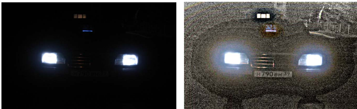
Рис. 2. Результати оброблення зображень алгоритмом Retinex, а) вхідне зображення, б) зображення із вирівняним освітленням
