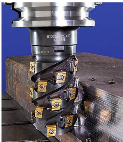
Рисунок 6.8 – Обробка складеною кінцевою фрезою із ЗБП
