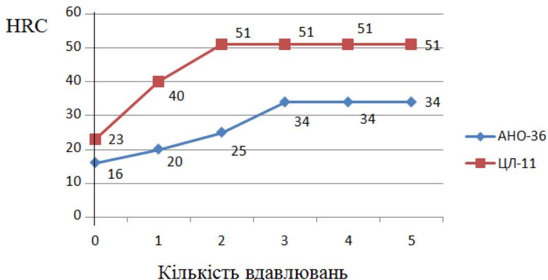
Рис.1. Залежність твердості наплавленого шару від кількості вдавлювань індентора
