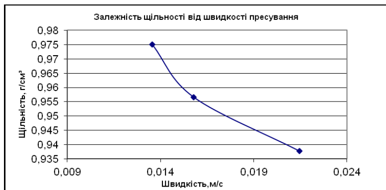
Рис. 4. Залежність щільності брикету від швидкості пресування
