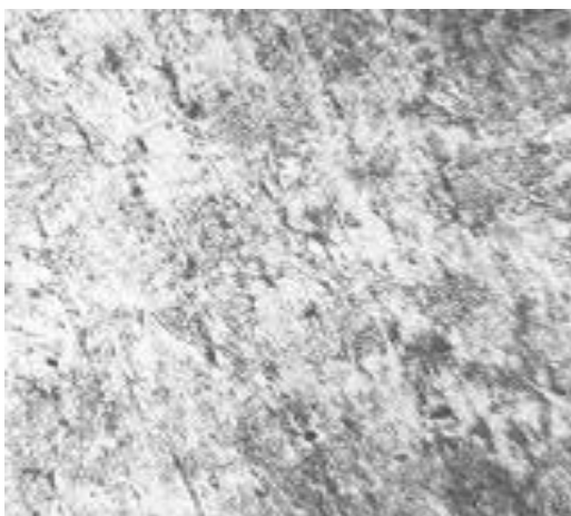
Рис.2. Структура металу шва
