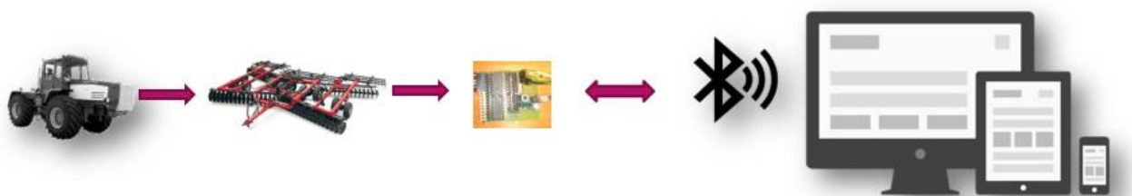
Рисунок 1 - Принцип роботи системи регулювання глибини обробки ґрунту. [1]
