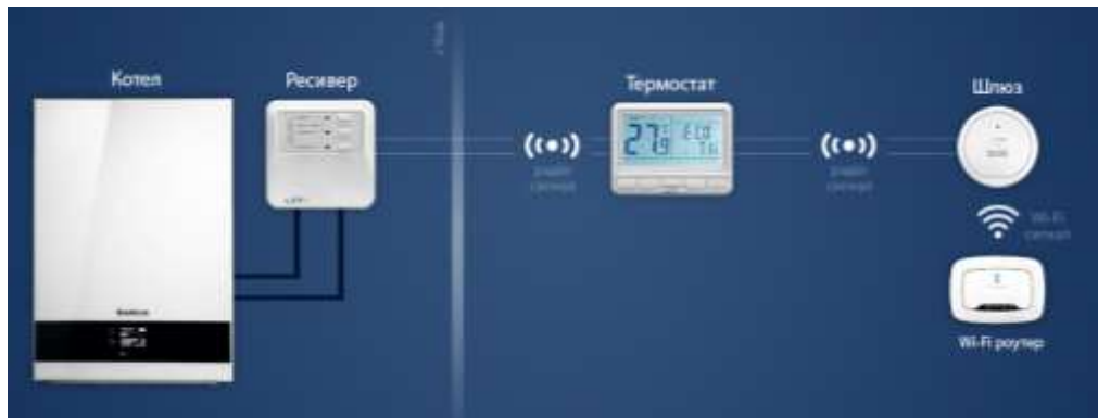
Рис. 1. Автоматизована система управління індивідуальним опаленням
