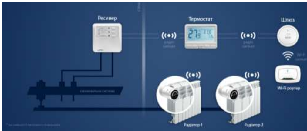
Рис. 2. Автоматизована система управління централізованим опаленням
