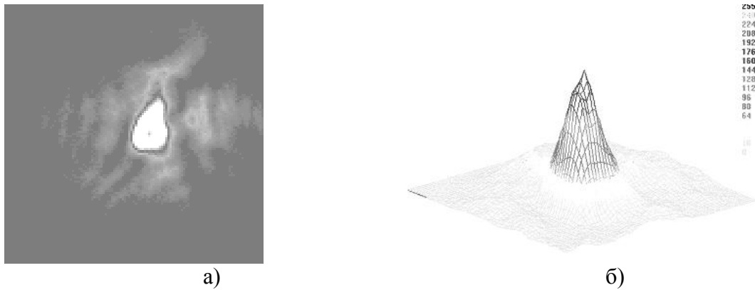
Рис. 1. Високоструктурований лазерний промінь, вимірний за допомогою CCD камери в 2D (а) і 3D (б) форматі
