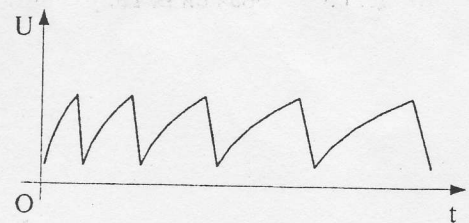
Рисунок 4. – Вихідний сигнал вимірювального перетворювача при \beta < 0
