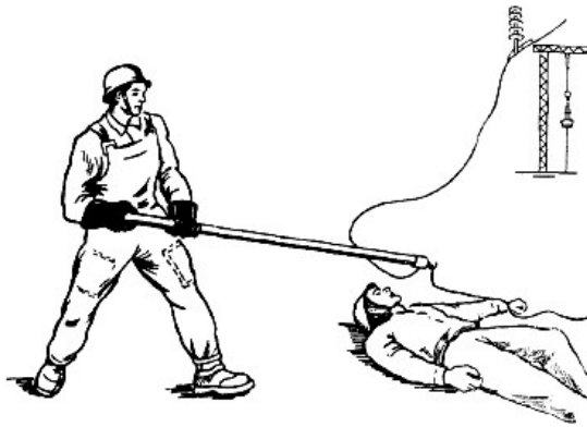
Рис. 4.16 – Звільнення потерпілого від дії струму в електроустановках напру- гою понад 1000 В ізолюючою штангою
