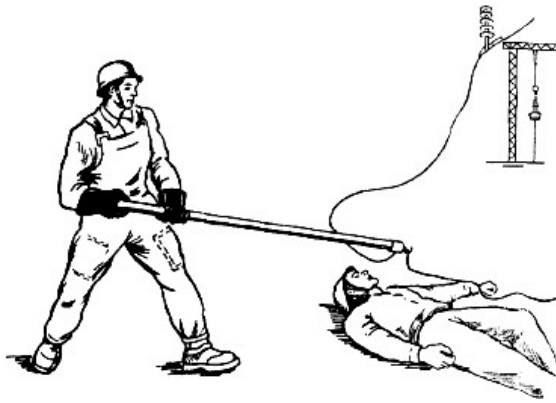
Рис. 6.16 – Звільнення потерпілого від дії струму в електроустановках напругою понад 1000 В ізольованою штангою
