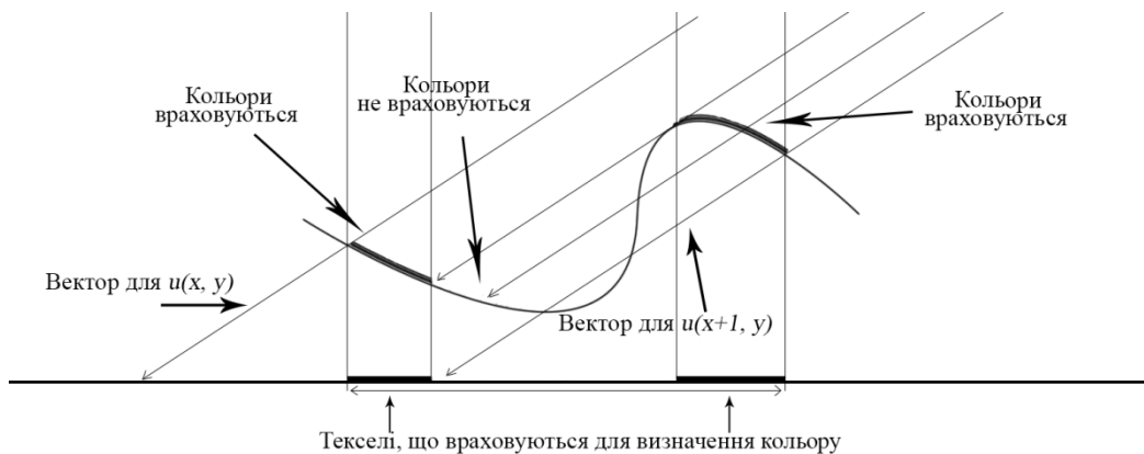
Рис. 5. Визначення текселів, що не повинні враховуватись при фільтрації
