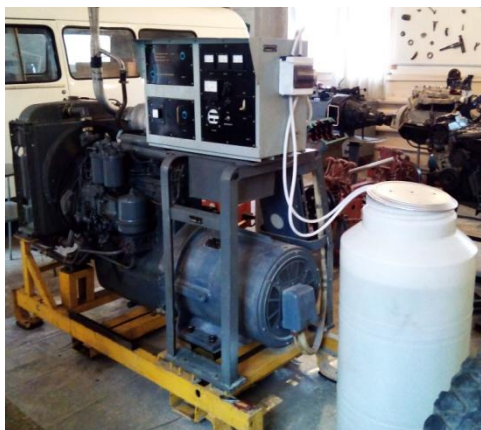
Рисунок 1 – Експериментальна установка для проведення досліджень впливу на показники дизеля використання динамічного регулювання відсоткового складу суміші дизельного та біодизельного палив
