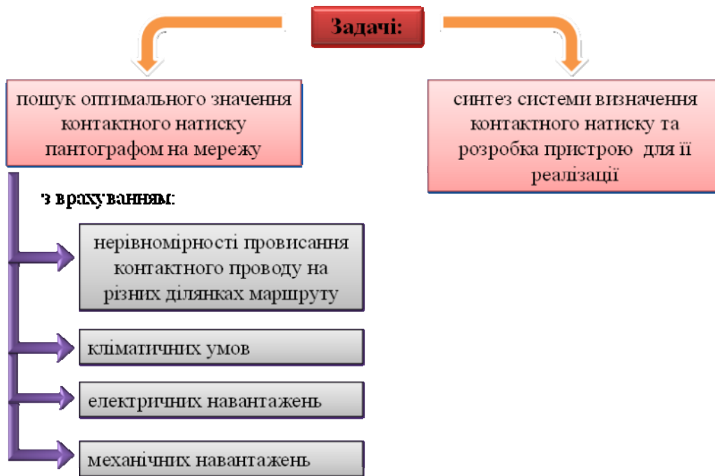
Рисунок 2.20 – Задачі для забезпечення оптимального процесу струмознімання
