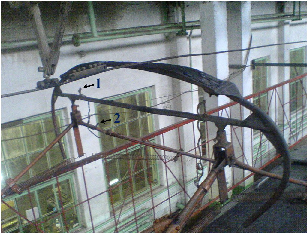
Рисунок 2.19 – Місця шунтування рухомих частин пантографа мідним проводом
